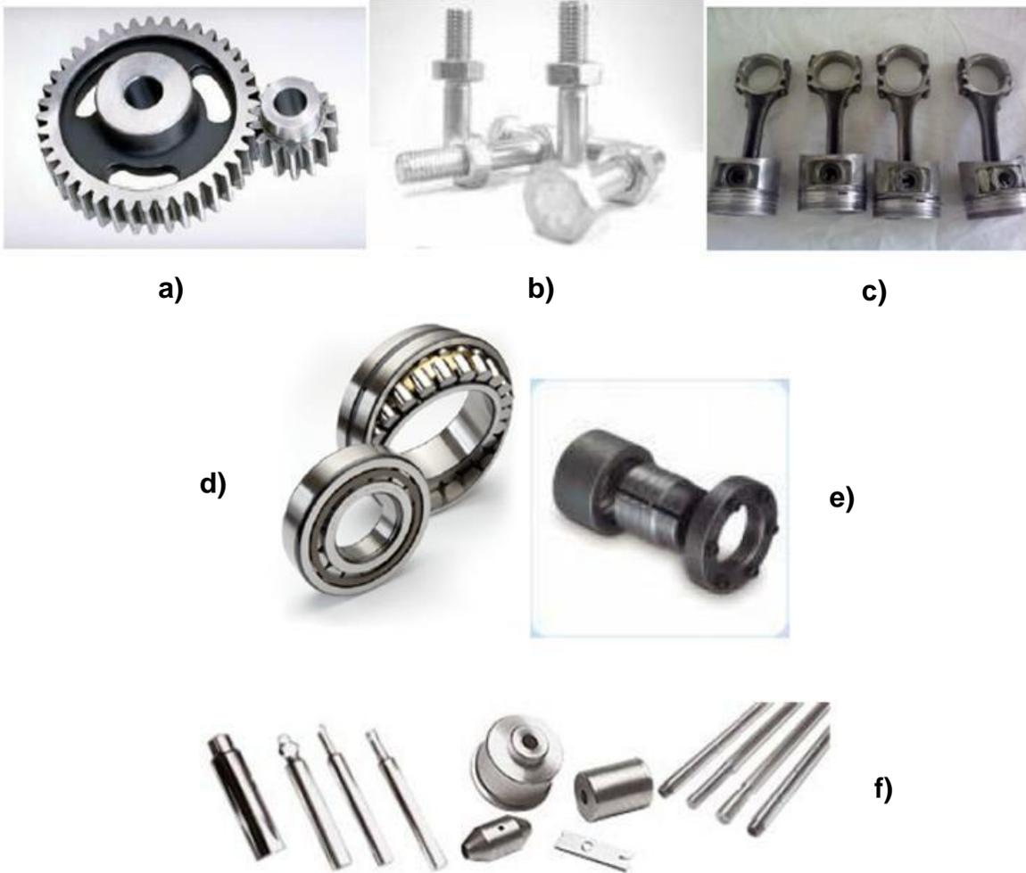
**Figura 1.7** Aplicaciones de aceros borurizados en la industria: (a) engranes (acero 1015), (b) pernos (acero 1045), (c) pistones (acero 4140, H12 y H13), (d) cojinetes (acero E52100), (e) bujes (acero D2, D3, 302, 316) y (f) pernos y dados para forja (acero L6).
