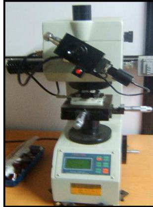
**Figura 3.12** Microdurómetro HVS-1000, laboratorio de Ingeniería de Superficies SEPI-ESIME ZACATENCO.
