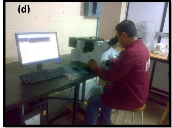
**Figura 3.4** *Proceso de preparación metalográfica; a) Encapsulamiento de las muestras por montaje en caliente, b) Proceso de desbaste, c) Proceso de pulido, d) Observación y determinación de espesores de capa.*
