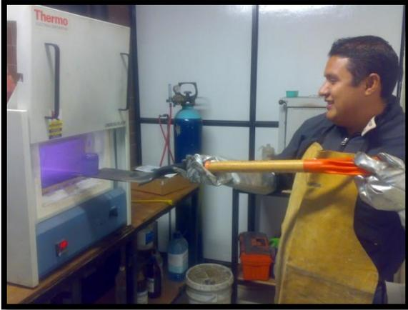
**Figura 3.3** Tratamiento de borurización en caja de una aleación base Fe-Cr-Ni, extracción del contenedor de la mufla, para enfriarse a temperatura ambiente.
