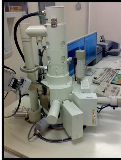
**Figura 3.9** Equipo de Microscopía electrónica de barrido.
