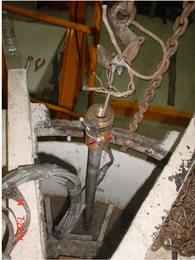
Fig. 3.19 Vista del modelo de pilote en extracción
