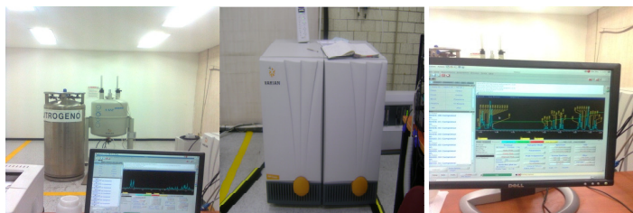
Figura. No.15 equipo de RMN de 300 MHz, NMR, OXFORD para caracterizar e identificar resultados.
