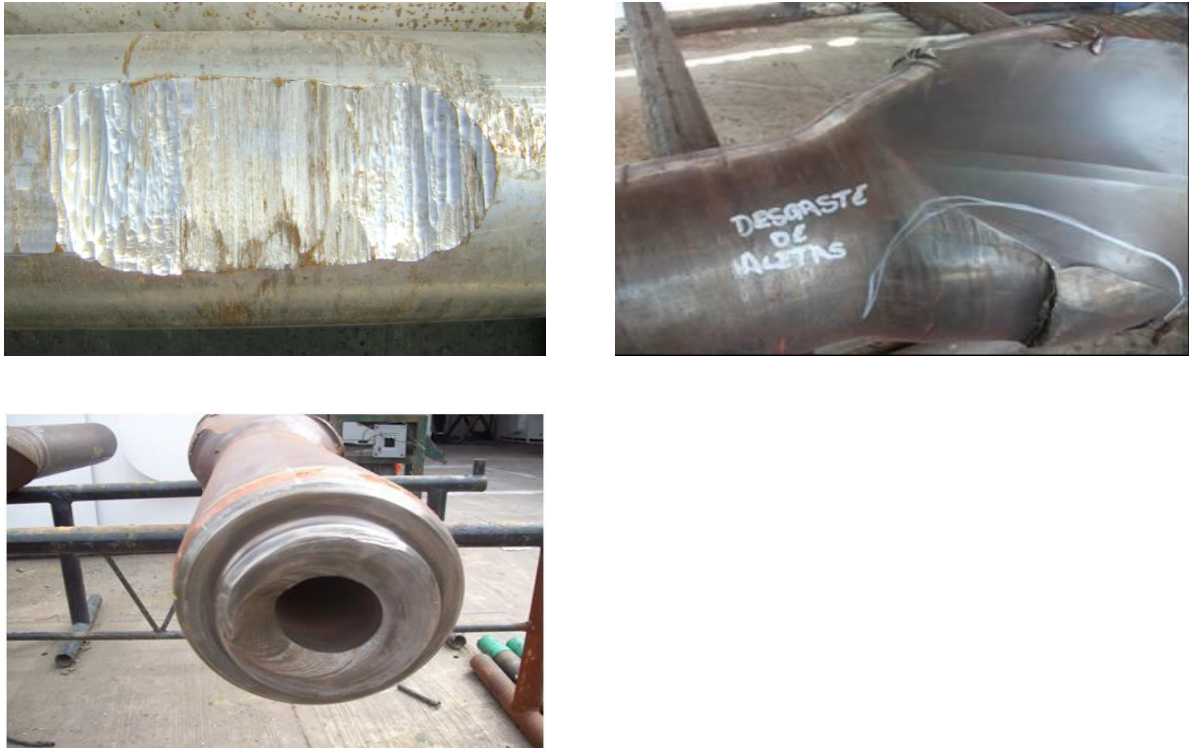
Figura 19. Fotografía del estabilizador, donde se observa daño por contacto de metal.
