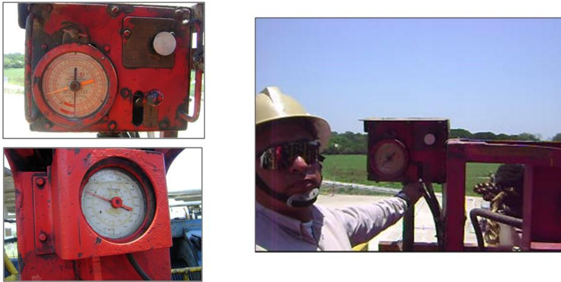
Figura 6. Pruebas realizadas al equipo ezy torque corroborando apriete adecuado considerando dos equipo de medición.
