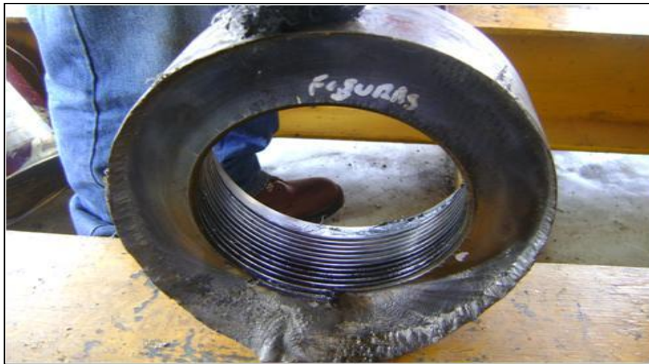
Figura 31. Drill collar 9 1/2" fracturado en su caja (4to. pez).
