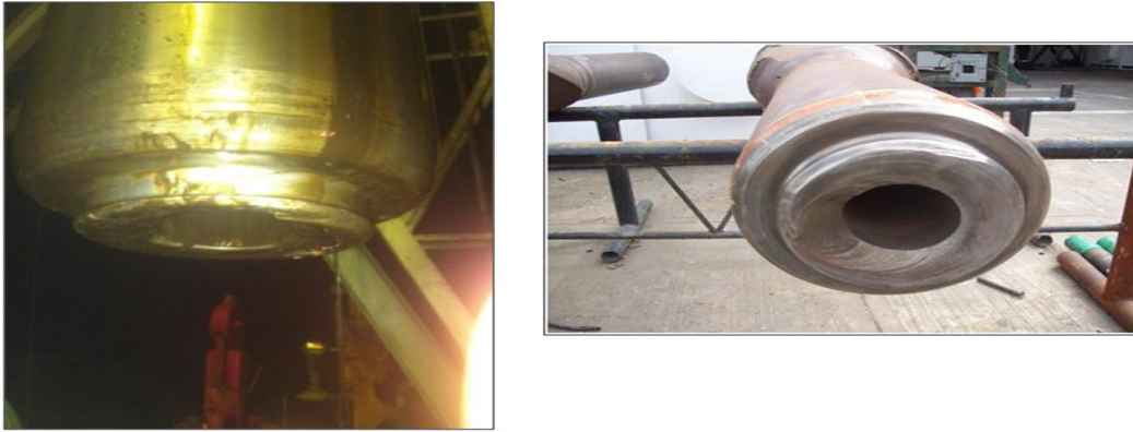
Figura 4. Piñón fracturado del estabilizador de 9 ½" x 17 ½" x 3" (primer pez).
