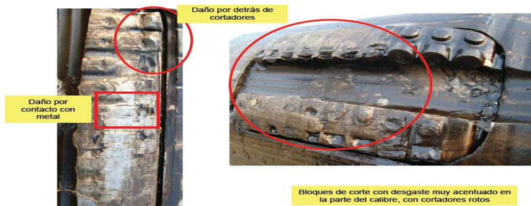
Figura 18. Fotografía del ampliador, donde se observa daño por contacto de metal.
