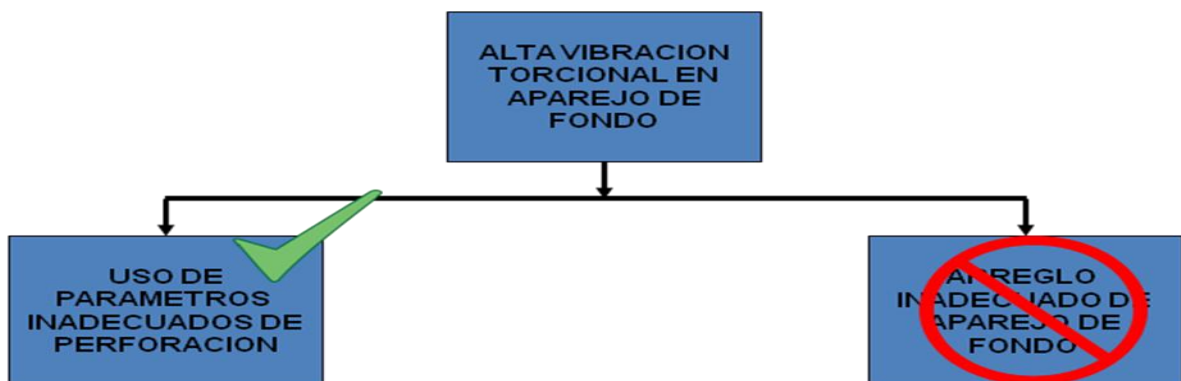
Esquema 5. Esquema final del análisis causa raíz tercer pez, 1397 m. Conclusión por alta vibración
