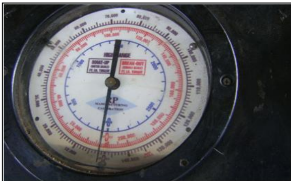
Figura 33. Prueba de medición de torque en conexión de 9 1/2" con caja fracturada
