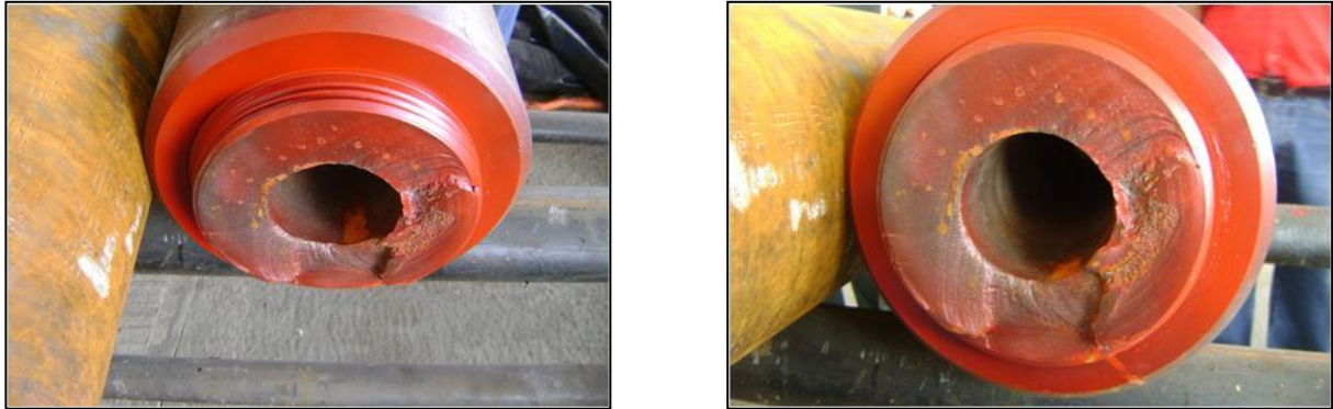
Figura 24. Piñón fracturado de sustituto vcp 9 1/2" (2do. pez)
