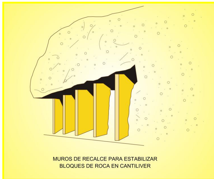
Figura 6.3 Muros para la estabilización de laderas.
