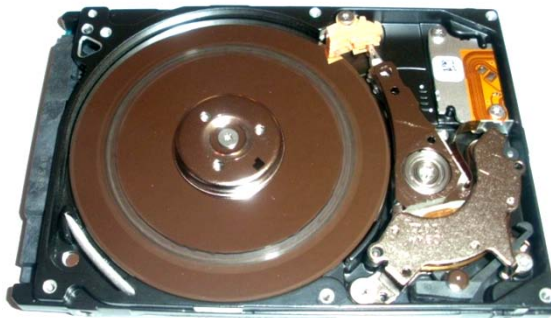
Figura 3.2. DDE con daño severo en la superficie del plato superior ( headcrash visible), irrecuperable.
