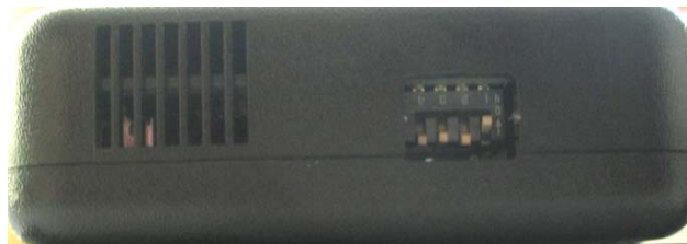
Figura 4.15. Activación de la escritura mediante Hardware.
