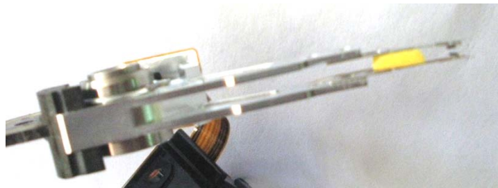
Figura A8.4. Separación de los sliders mediante foami.
