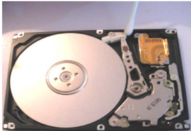
Figura 3.5. Aplicación del “head cleaner” mediante el dynamic load/unload .
