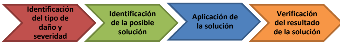
Figura 4.6. Fases de la reparación física temporal.
