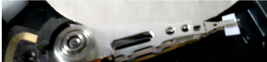
Figura A8.3. Separación de los sliders mediante un trozo de papel.
