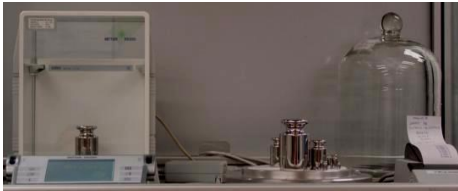
Figura 2.4. Determinación de la densidad de un sólido. Laboratorio de metrología mecánica - CENAM
