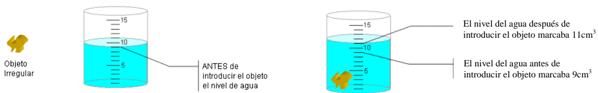
Figura 2.1. Volumen del objeto de acuerdo al nivel del agua desplazado
