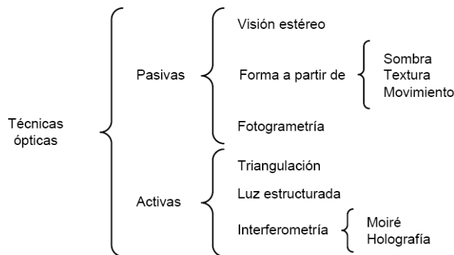
Figura 2.10. Clasificación de las técnicas ópticas para la obtención de información 3D de una escena
