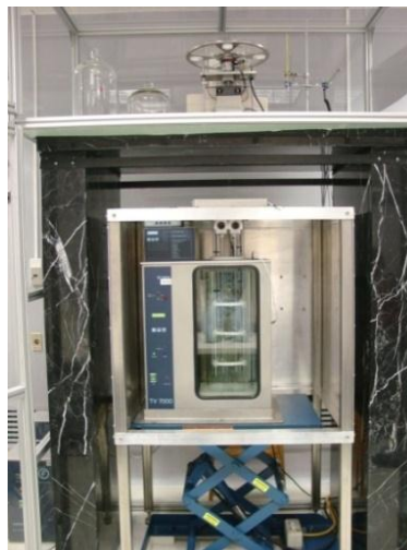
Fig. 3.2 Sistema de Pesada Hidrostática del Patrón Nacional de Densidad
