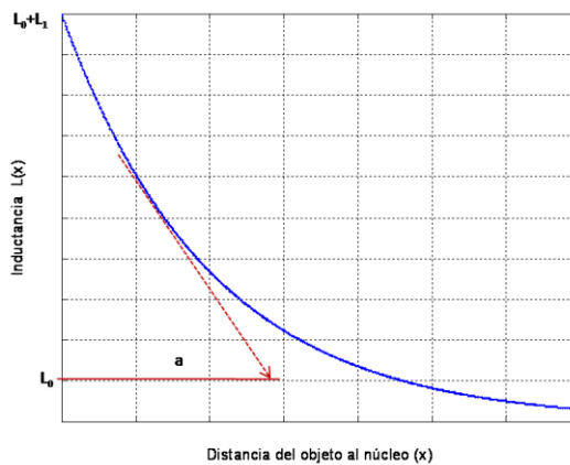
Fig. 2.3 Comportamiento Inductancia vs distancia del objeto a levitar del núcleo
