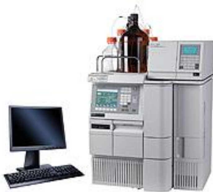
Figura 9.- Imagen del cromatógrafo de líquidos de Alta Resolución modulo Alliance 2695, utilizado en el análisis de las muestras del estudio.
