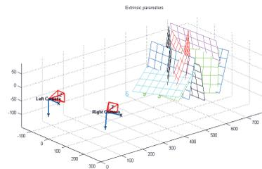
**Figura 1.** Cámaras calibradas, donde se conoce la transformación rígida del sistema de coordenadas de la cámara izquierda a la cámara derecha.
