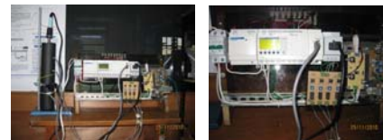
Fig. 2.- Montaje experimental, se observa la barra y el PLC.
