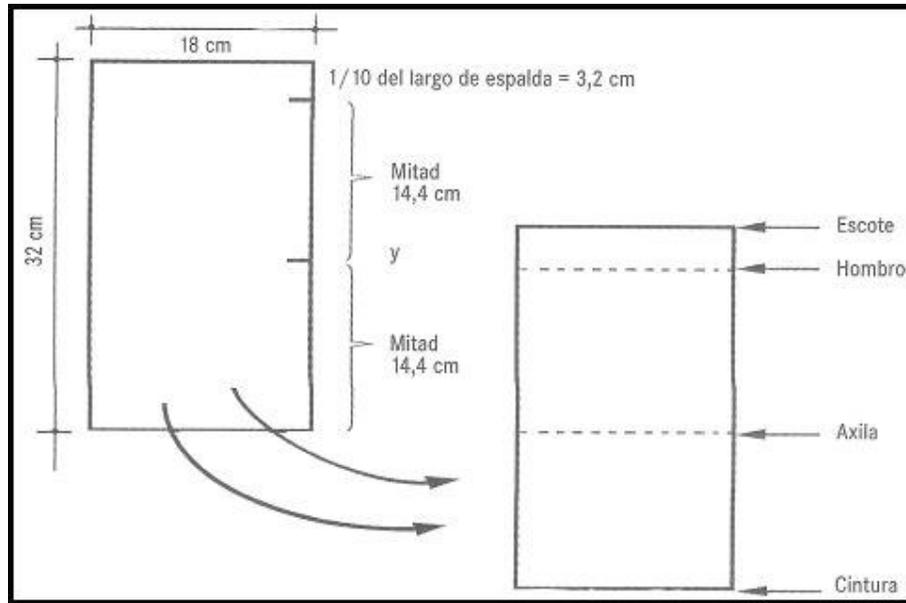
**Figura 3.2:** División de la *vasija* del molde base trasero en el Sistema Zampar
