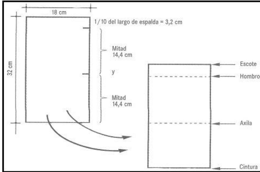
**Figura 4.9:** Trazo de las *alturas de hombro, axila y cintura* en el Sistema Zampar
