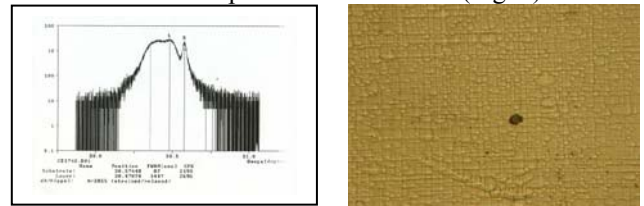
Figura. 1 Difractograma y fotografía de la superficie de una película tensionada de InGaAs crecida sobre GaSb
