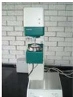
Para realizar el análisis, se utilizó un reómetro marca HAAKE con un software instalado en su versión 3.11.01, además de una placa rugosa (conocida como sensor PP35).
