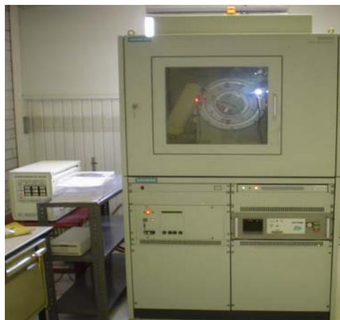
Figura 3.1 Difractómetro de rayos X
