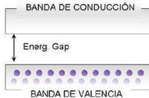
Figura 1.6. Energía de bandas en un semiconductor
