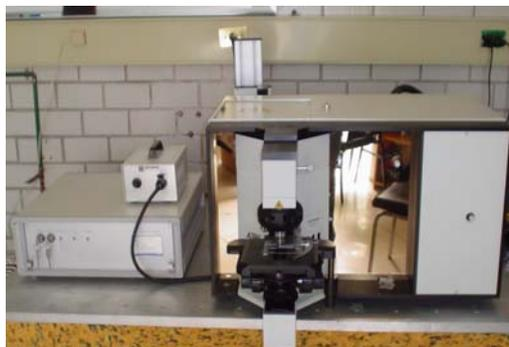
Figura 3.3. Espectrofotómetro Raman
