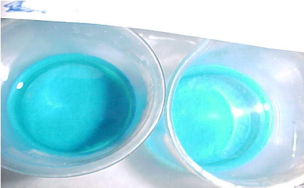
**Lámina mostrando los dos vasos con solución de azul de metileno, el de la izquierda sin excitación ultrasónica y el de la derecha irradiado ultrasónicamente.**
