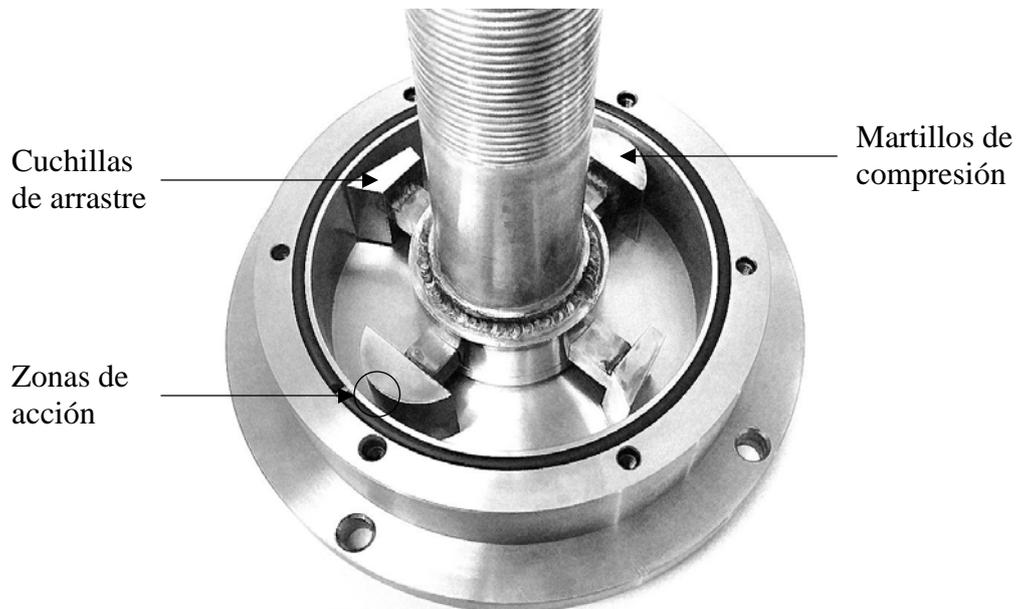
Fig. 3.5 Ensamble del sistema interior estático
