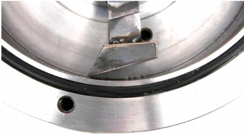
Fig. 4.2 Entrefierro de la pala de arrastre con la pared de la cámara del reactor
