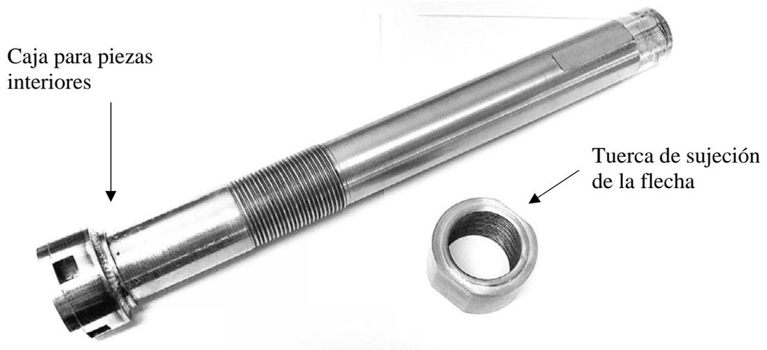
Fig. 3.6 Flecha de sujeción de piezas interiores y de alimentación de polvos
