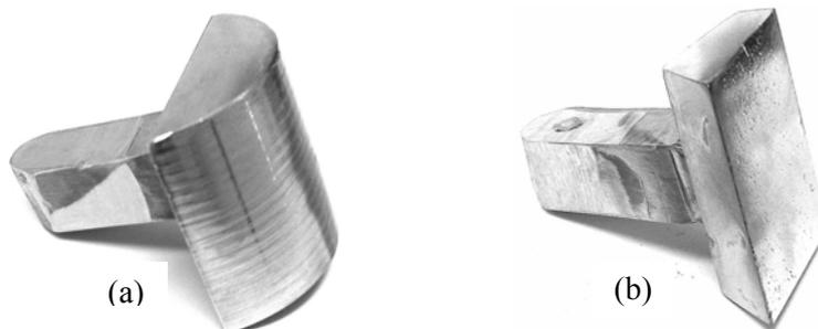
Fig. 3.4 Piezas interiores; (a) martillo de compresión y (b) cuchilla de arrastre
