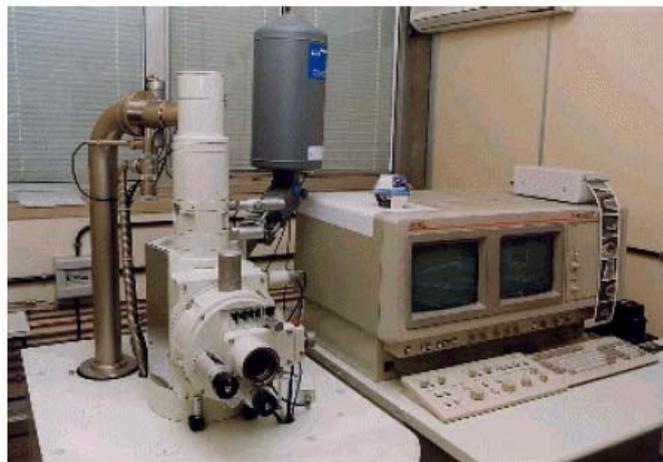
**Figura 4.3.** Microscopio Electrónico de Barrido Modelo JSM-63000.
