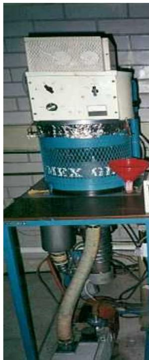
**Figura 4.1.** Sistema de Sputtering por radio Frecuencia.
