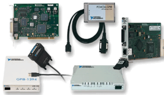
Fotografía 3.3. Instrumentos de control GPIB de Nacional Instruments
