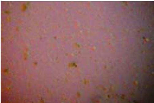
Figura32. Películas epitaxiales de GaAs Tm 650°C, GaAlAs, aproximadamente 100x60 \mu\text{m}^2 características morfológicas MOCVD.
