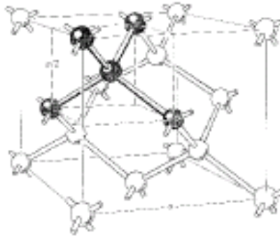
Figura 1. Disposición espacial de la estructuras zinc blenda.
