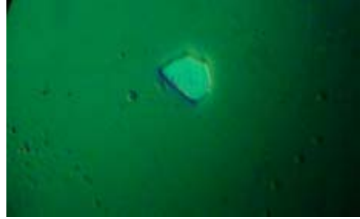
Figura 34. Películas epitaxiales de GaAs Tm 650°C, GaAlAs, aproximadamente 100x60 \mu\text{m}^2 características morfológicas MOCVD
