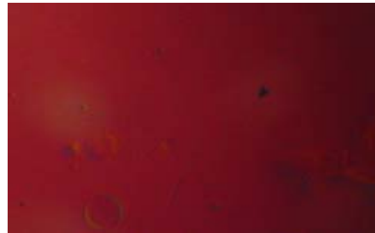
Figura32. Películas epitaxiales de GaAs Tm 650°C, GaAlAs, aproximadamente 100x60 \mu\text{m}^2 características morfológicas MOCVD.
