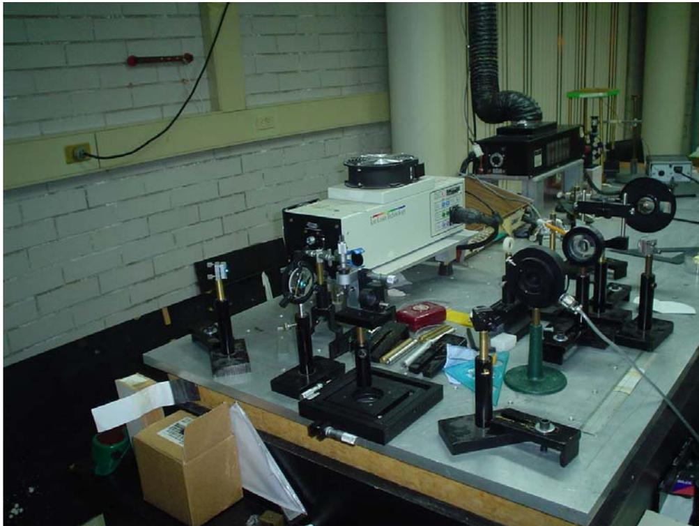
**Figura 0.19** *Fotografía del montaje experimental para la medición de la cintura del láser.*
