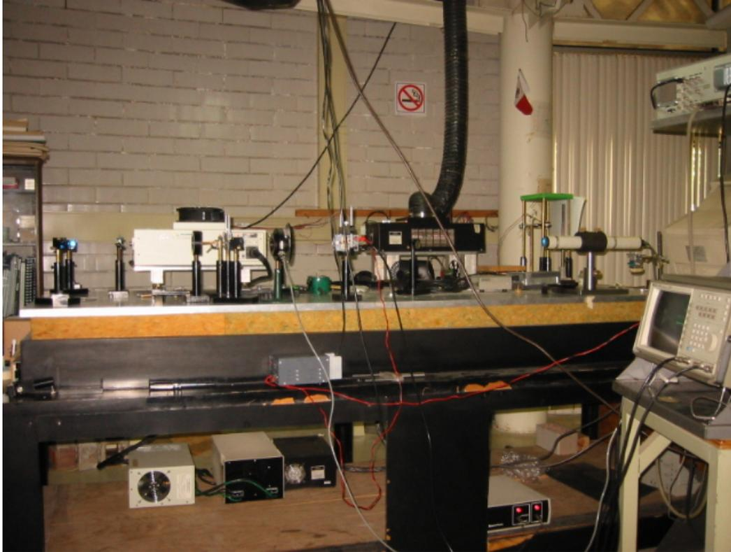
**Figura 0.4** *Fotografía del montaje experimental de la lente térmica.*
